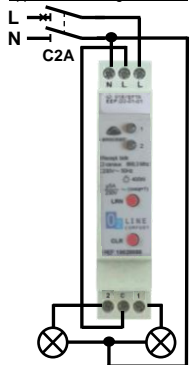
Schéma de raccordement pour application éclairage ≤ 400W :
