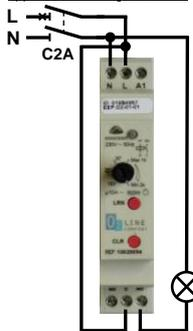
Schéma de raccordement pour charge résistive ≤ 2300W :
