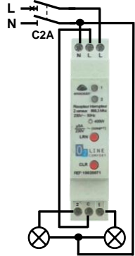
Schéma de raccordement pour application éclairage ≤ 400W :
